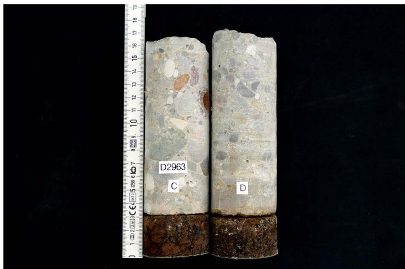
Bild 18 Bohrkerne C und D aus der Deckenunterseite der Sondage-
