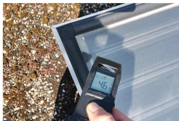
Abbildung 132: Gemessen ca. 42-46°C Vorlauftemperatur durch Sonne im Heizsystem
