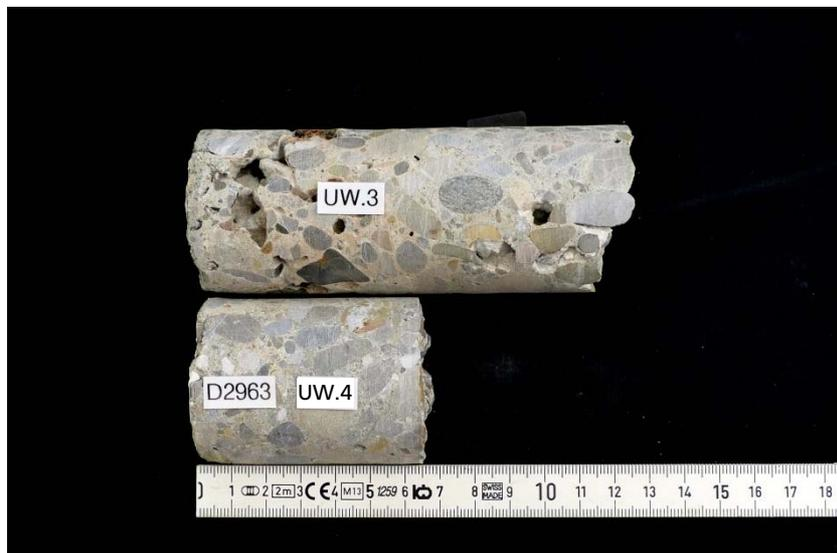
Bild 20 Bohrkerne UW.3 und UW.4 aus der Wand (Beckenaussenseite).
