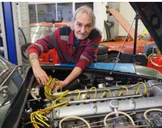
Jenő Csikos am Montieren der gelben Zündkabel
