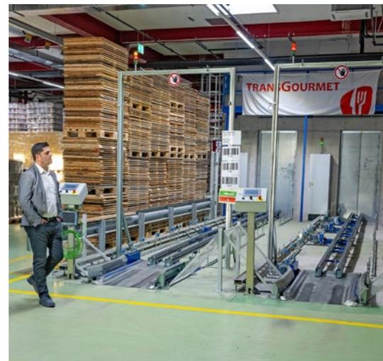
Ein Blick ins Lager der TransGourmet. Über diesen Lift können Paletten automatisch in alle drei Stockwerke gebracht werden.
