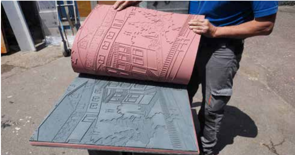
Für die Herstellung der drei Bilder aus glasfaserverstärktem Kunststoff ist eine Negativform aus Gummi erforderlich. Von dieser können jederzeit weitere Exemplare hergestellt werden.
